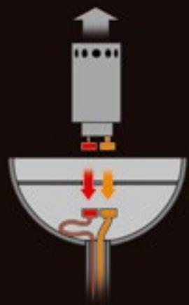
Der Gasfackel-Brenner ist einfach an- und absteckbar (ohne Werkzeug).
