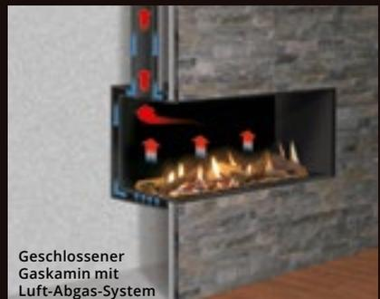
Geschlossener Gaskamin mit Luft-Abgas-System
